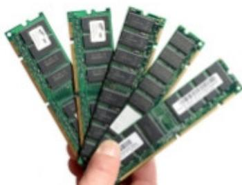
La **memoria principal** es aquella memoria de un ordenador donde se almacenan temporalmente tanto los datos como los programas que la CPU está procesando o va a procesar en un determinado momento. Por su función, trabaja conjuntamente con el microprocesador, con el cual se comunica a través de los buses de datos. Por ejemplo, cuando la CPU tiene que ejecutar un
